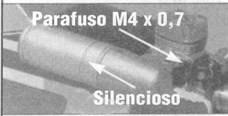
Instale o parafuso M4x0.7 (M5 para 2500 e maiores), a arruela de pressão e a porca de 4mm (M5 para 2500 e maiores) no silencioso, mas não aperte. Encaixe o silencioso no coletor de forma que ele não encoste na fuselagem. Para reduzir o arrasto é melhor instalar o silencioso paralelo à fuselagem. Aperte o parafuso M4x0.7 (M5 para 2500 e maiores) quando o silencioso estiver posicionado corretamente.
